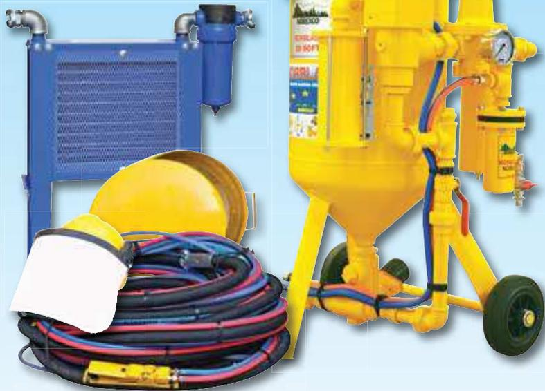
**NORBLAST® 35 SOFT** permet de nettoyer et de décaper un très grand nombre de supports tels que le bois, la pierre naturelle, la brique, le béton, le laiton, le cuivre, l'aluminium, etc... Ce système est particulièrement recommandé pour l'effacement des graffiti et le décapage des peintures sur la quasi-totalité des supports pour des surfaces de faibles à moyenne importance.
